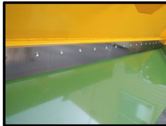
切断刃は5枚使い、損傷しても部分的な交換をする事が出来ます。
