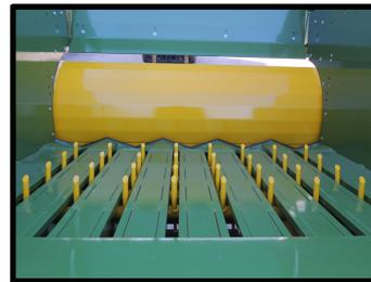
傾斜のついた床面と間欠搬送によりロールペールを確実に送ります。
