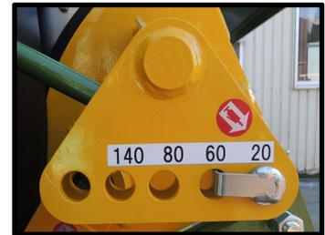
切断長の200mmは140mmのポジションで2回送りにする事で作業出来ます。
